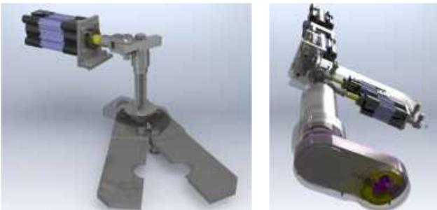
El cabezal de llenado es un grupo móvil que únicamente tiene movimiento vertical hidráulico de modo que la altura de éste se ajusta proporcionalmente al peso de la bolsa según aumenta la entrada de producto en esta, evitando las tensiones y esfuerzos producidos entre la boquilla y el saco, además de facilitar el control de pesaje y aumentar la precisión de llenado.
